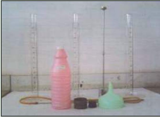
รูปที่ 3-10 การทดสอบคุณสมบัติหินฝุ่น โดยวิธีหาค่าสมมูลย์ของทราย
