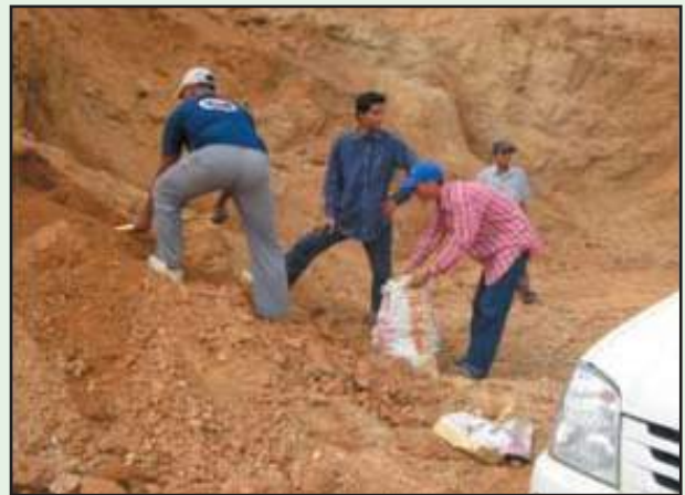
รูปที่ 3- 4 การเก็บตัวอย่างจากสายพาน และการเก็บตัวอย่างจากแหล่งวัสดุ
