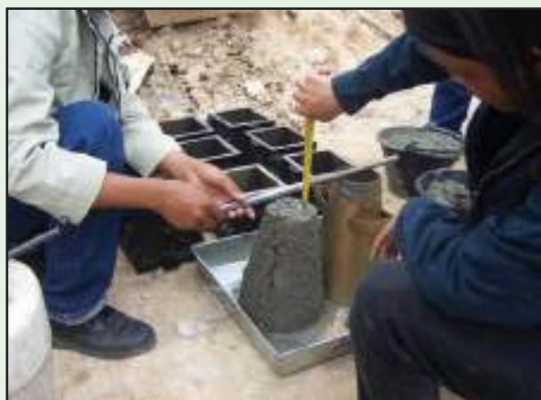
รูปที่ 5-27 การตรวจสอบความชื้นเหลือของคอนกรีต
