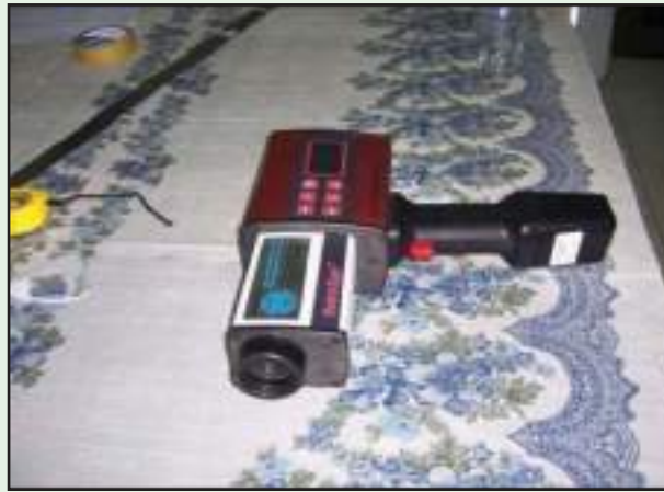
รูปที่ 7-3 การตรวจสอบด้วยเครื่องมือตรวจสอบการสะท้อนแสง (Retro Sign)
