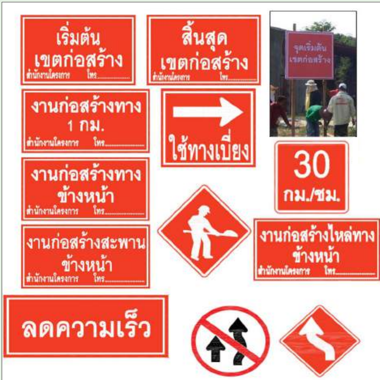
รูปที่ 8-2 ตัวอย่างป้ายจราจรในระหว่างการก่อสร้างถนน
