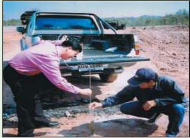
รูปที่ 3-10 การทดสอบคุณสมบัติหินฝุ่น โดยวิธีหาค่าสมมูลย์ของทราย
