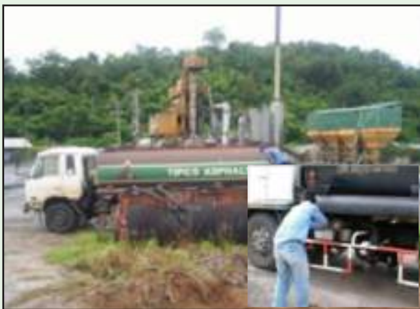
รูปที่ 6-9 การตรวจสอบซีลรถนำส่งยางที่ด้านข้างและด้านบนต้องอยู่ในสภาพสมบูรณ์
