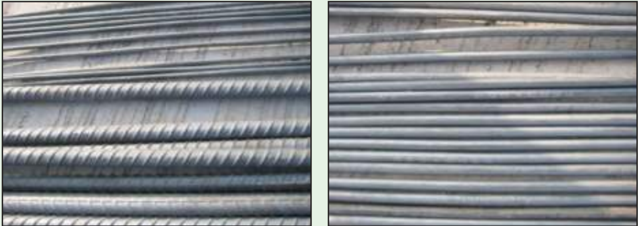
รูปที่ 3-16 เหล็กข้ออ้อย (Deformed Bar) และเหล็กเส้นกลม (Round Bar)
