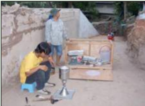
รูปที่ 4-22 การทดสอบความแน่น โดยวิธี Sand Cone Test
