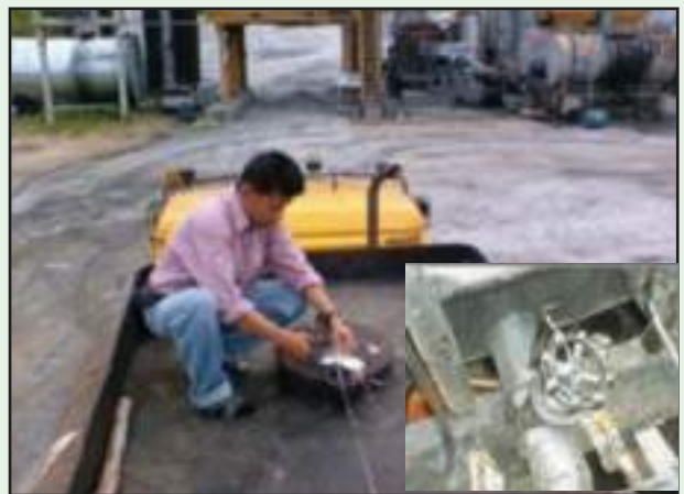
รูปที่ 6-9 การตรวจสอบซีลรถนำส่งยางที่ด้านข้างและด้านบนต้องอยู่ในสภาพสมบูรณ์
